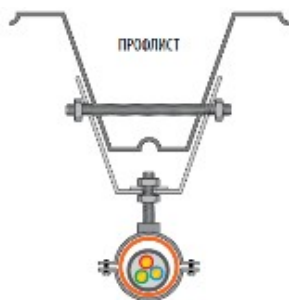
Рисунок 8 - Монтаж ОКЛ в обхват горизонтальных металлических конструкций
