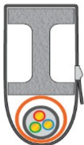
Рисунок 8 - Монтаж ОКЛ в обхват горизонтальных металлических конструкций
